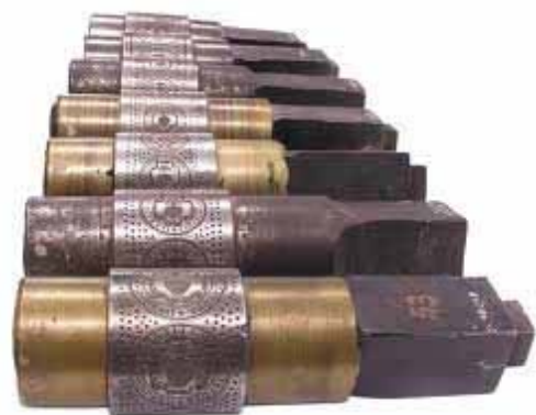
figura 9.- Diversos cuños cilíndricos utilizados en ingenios de acuñación
